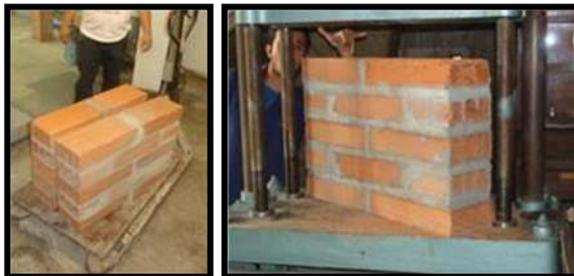
a) Elaboración de Muretes    b) Montaje en la Prensa (LABEST)
