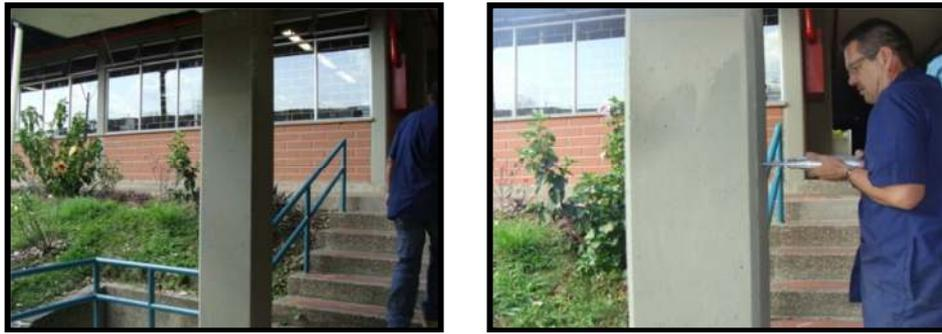
**Fotografía 4.13** Ensayo con el Martillo de Rebote (Esclerómetro)- Columna B2-B5
